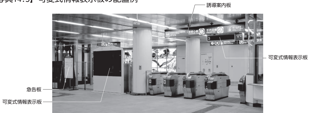
【写真14.5】 可変式情報表示板の配置例
